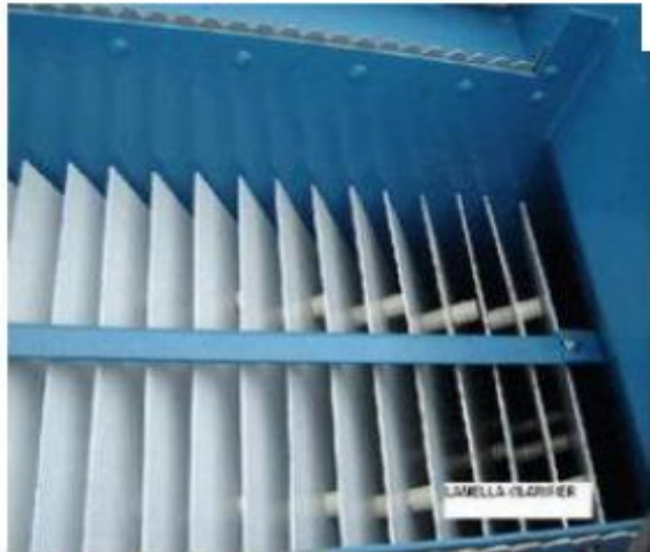
Slika 26. Prikaz dijela lamelnog (lijevo) i cjevastog (desno) taložnika
